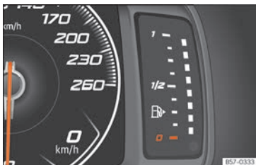
Rys. 121 Cyfrowa tablica przyrządów: wskaźnik poziomu paliwa.
