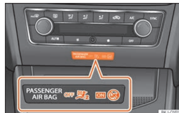
Rys. 26 Środkowa część deski rozdzielczej; lampka kontrolna wyłączenia czołowej poduszki pasażera w konsoli środkowej.
