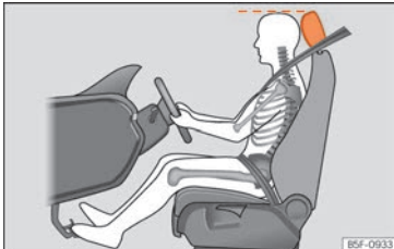
Rys. 86 Prawidłowe ustawienie zagłówka kierowcy.
