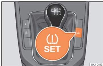
Rys. 274 Konsola środkowa: przycisk systemu monitorowania opon
