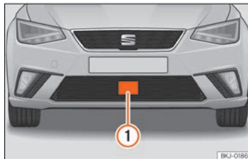
Rys. 232 Na przednim zderzaku: czujnik radarowy.
