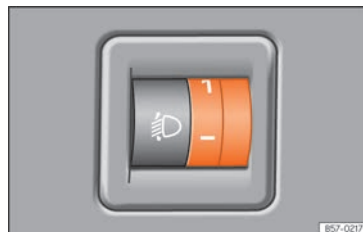
Rys. 145 Tablica przyrządów: regulacja zasięgu reflektorów.
