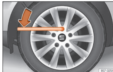
Rys. 74 Zmiana koła: poluzować śruby koła.
