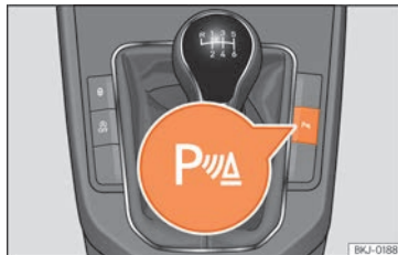
Rys. 245 Konsola środkowa: przycisk wspomaganie parkowania (w zależności od wersji).
