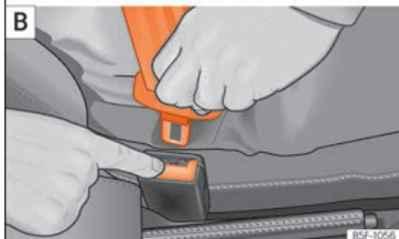
Rys. 18 Ułożenie pasa bezpieczeństwa i odpięcie klamry pasa.
