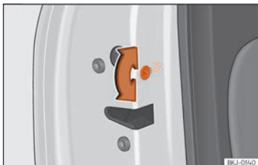
Rys. 139 Blokada drzwi przed dziećmi w drzwiach lewych.
