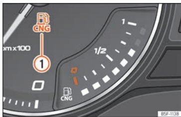
Rys. 122 Analogowa tablica przyrządów: wskaźnik poziomu gazu
