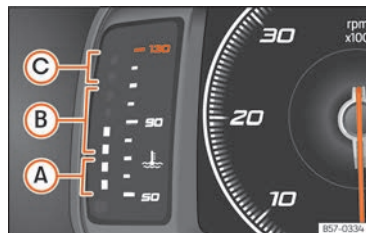
Rys. 124 Cyfrowa tablica przyrządów: wskaźnik temperatury płynu chłodzącego silnika.
