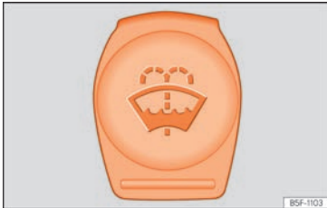
Rys. 63 W komorze silnika: korek zbiornika płynu do spryskiwaczy.
