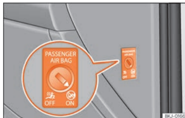
Rys. 25 Przełącznik czołowej poduszki powietrznej pasażera.
