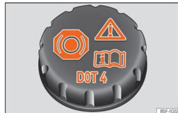
Rys. 62 Komora silnika: korek zbiornika płynu hamulcowego.
