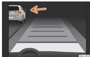
Rys. 240 Na wyświetlaczu tablicy rozdzielczej: ACC aktywny, wykryto pojazd na lewym pasie
