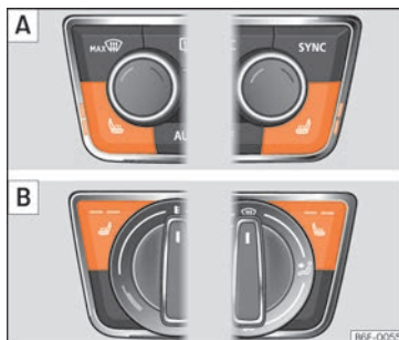
Rys. 151 Na konsoli środkowej: przelącznik podgrzewania przednich foteli | A : wersja z Climatronic | B : wersja z klimatyzacją ręczną.
