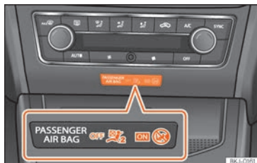
Rys. 97 Środkowa część deski rozdzielczej; lampka kontrolna wyłączenia czołowej poduszki pasażera w konsoli środkowej.
