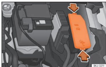
Rys. 65 W komorze silnika: pokrywa skrzynki bezpieczników.
