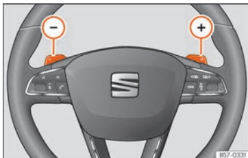
Rys. 223 Kierownica: łopatki automatycznej zmiany biegów
