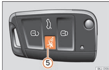
Rys. 131 Klucz samochodowy z przyciskiem alarmu.
