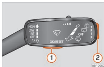
Rys. 125 Dźwignia wycieraczek szyby przedniej: przyciski sterujące.
