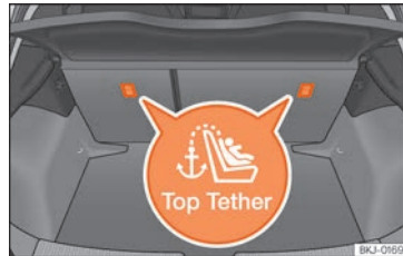
Rys. 35 Umiejscowienie uchwyty Top Tether za tylnym siedzeniem.
