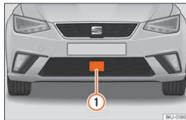
Rys. 237 Na przednim zderzaku: czujnik radarowy.
