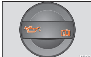
Rys. 60 W komorze silnika: Korek wlewu oleju silnikowego.
