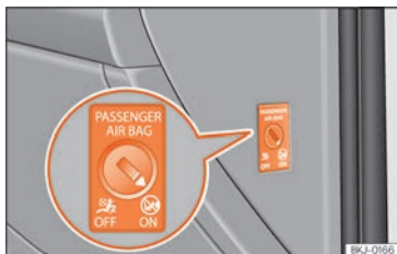
Rys. 96 Przetącnik czołowej poduszki powietrznej pasażera.
