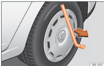
Rys. 72 Zdjąć kotpak z koła.
