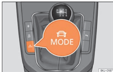
Rys. 243 Obok dźwigni zmiany biegów: Przycisk MODE [TRYB].
