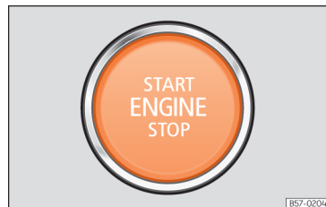
Rys. 115 W dolnej części konsoli środkowej: przycisk rozrusznika.
