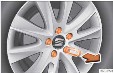
Rys. 238 Koło: śruby kół z nasadkami.
