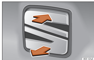
Rys. 78 Kłapa bagażnika: otwierana od zewnątrz.
