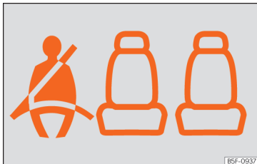
Rys. 23 Zestaw wskaźników: wskazanie stanu pasów bezpieczeństwa tylnych siedzeń.
