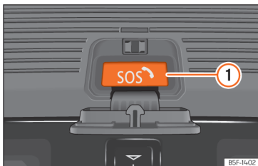
Rys. 54 Przycisk połączenia z numerem alarmowym
