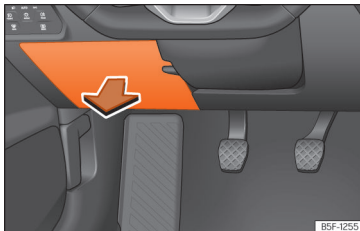
Rys. 215 Na desce rozdzielczej po stronie kierowcy: pokrywa skrzynki bezpieczników.
