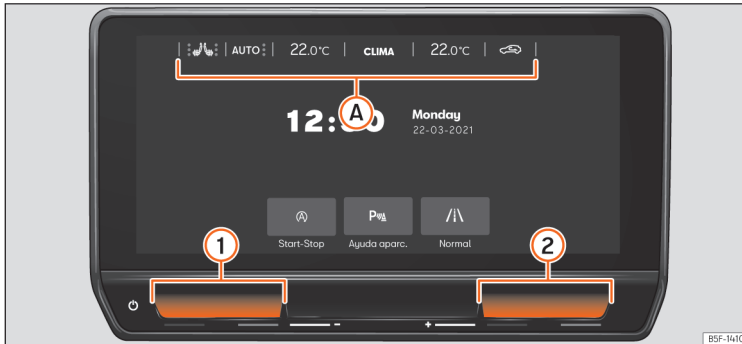
Rys. 111 Schemat: funkcje klimatyzacji
