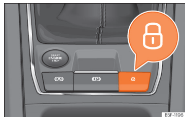
Rys. 74 Na konsoli środkowej: przycisk zamka centralnego
