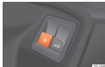
Rys. 203 Drzwi kierowcy: zwalnianie klapy wlewu.
