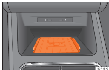
Rys. 173 Konsola środkowa: slot do podłączenia telefonu komórkowego.
