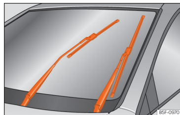
Rys. 207 Wycieraczki w położeniu serwisowym.
