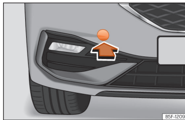
Rys. 211 Zderzak przedni po prawej stronie: zdejmowanie pokryw.
