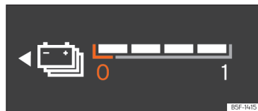
Rys. 8 Zestaw wskaźników cyfrowych: wskaźnik poziomu akumulatora.
