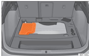
Rys. 229 Pojazdy hybrydowe (PHEV): umiejscowienie akumulatora w bagażniku
