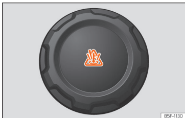
Rys. 222 Komora silnika: korek zbiornika wyrównawczego płynu chłodzącego.
