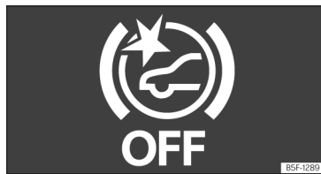
Rys. 138 Wyłączony komunikat Front Assist na ekranie tablicy wskaźników.
