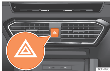
Rys. 52 Deska rozdzielcza: włącznik świateł awaryjnych.
