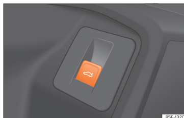
Rys. 80 Drzwi kierowcy: przycisk otwierania i zamykania kłapy bagażnika.
