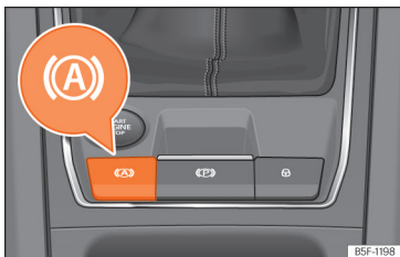
Rys. 148 W dolnej części konsoli środkowej: Przycisk funkcji Auto Hold.
