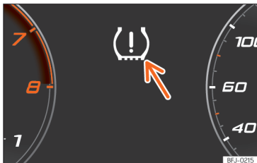
Rys. 244 Tablica przyrządów: ostrzeżenie o spadku ciśnienia w oponach.
