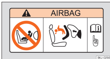
Rys. 42 Naklejka z symbolem poduszki powietrznej: na osłonie przeciwstycznej po stronie pasażera
