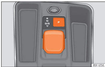
Rys. 119 Na konsoli środkowej: dźwignia zmiany biegów.
