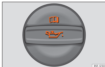
Rys. 228 Ostonka korka wlewu oleju w komorze silnika
