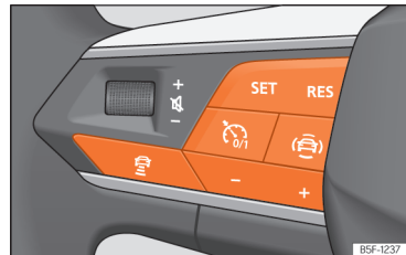
Rys. 132 Na kierownicy wielofunkcyjnej: przyciski do obsługi tempomatu ACC.
