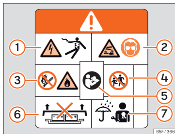
Rys. 56 Napis ostrzegawczy akumulatora wysokonapięciowego.
