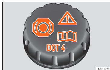
Rys. 223 Komora silnika: korek zbiornika płynu hamulcowego.
