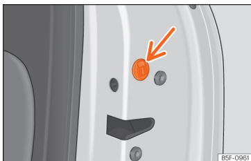
Rys. 76 Ręczne rygłowanie drzwi.
