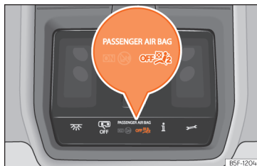
Rys. 33 Na konsoli podsufitce: lampka kontrolna dezaktywacji poduszki powietrznej pasażera.
