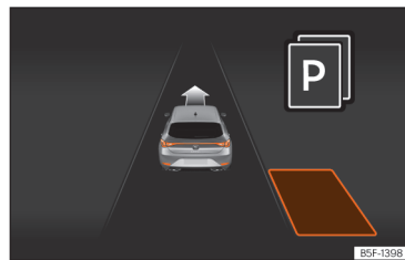
Rys. 151 Na wyświetlaczu tablicy przyrządów: wyświetlanie układu wspomaganie parkowania przy ograniczonej widoczności.
