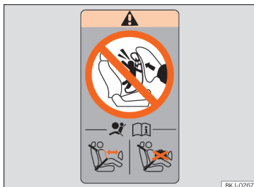
Rys. 43 Naklejka z symbolem poduszki powietrznej: w tylnej części ramy drzwi po stronie pasażera.
