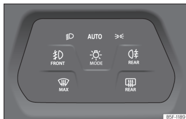
Rys. 101 Tablica przycisków: przetłacznik świateł.
