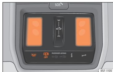
Rys. 103 Szczegółowy widok podsufitki: oświetlenie przedniej części wnętrza.
